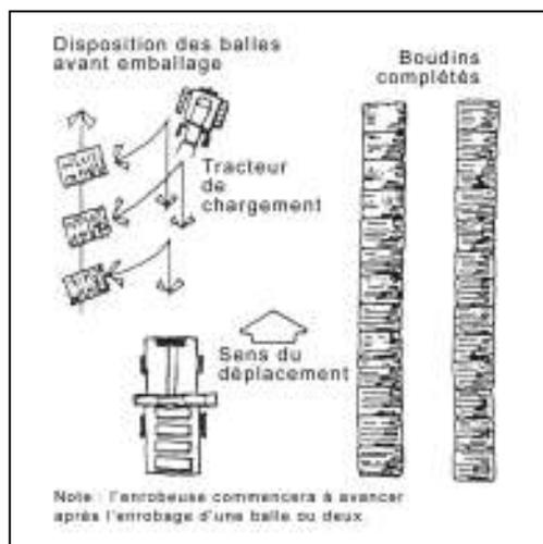
Lorsque les balles sont amenées au site avant l'emballage, elles sont disposées de façon à être facilement accessibles et en laissant suffisamment d'espace pour les déplacements du tracteur et de l'enrobeuse.
