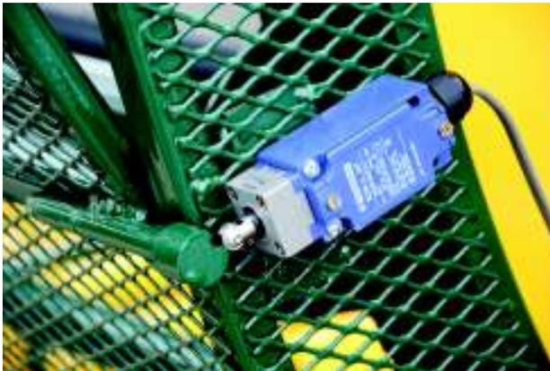
photo #3 interrupteur de sécurité
